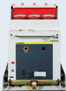
Вакуумные выключатели • по стандартам IEC (МЭК) 7,2-17,5кВ, 8-50кА, 400-4 000А 24/25,8кВ, 12,5-40кА, 630-3 150А 36/40,5кВ, 25-31,5кА, 1 250-3 150А • по стандартам ANSI 4,76/15кВ, 25/40кА, 1 200-3 000А 38кВ, 31,5-40кА, 1 200-3 000А
